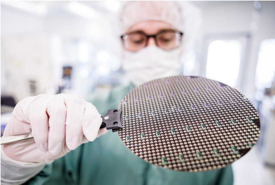
Leistungsbaulemente auf einem Siliziumkarbid-Wafer, hergestellt im institutseigenen Reinraum des Fraunhofer IISB. © Daniel Karmann / Fraunhofer IISB
