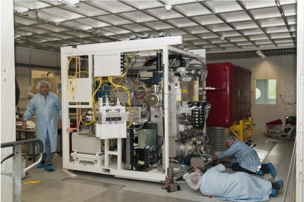
*Montage der neuen Mittelstrom-Implantationsanlage im Reinraum.
