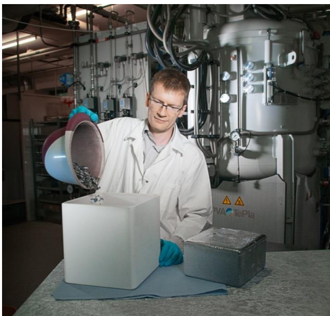
Dr. Matthias Trempa beim Befüllen eines Tiegels mit Silizium-Rohstoff
