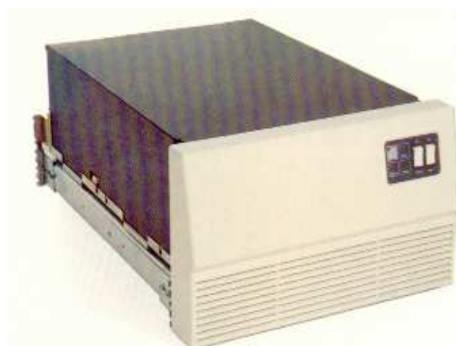
Bild 1: Magnetplatte aus dem ersten Institutsrechner des IISB (1985): System Industries 9751, Kapazität 474 MByte unformatiert, Abmessungen ca. 26 cm · 44 cm · 48 cm
