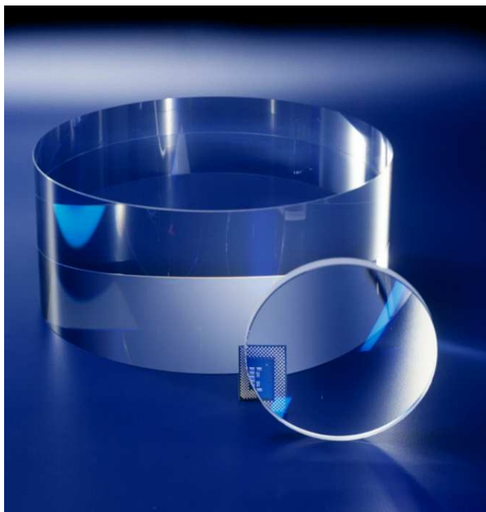
„Perfekte“ \text{CaF}_2 - Kristalle als Linsenmaterial für die Mikrolithographie, die nach einem modifizierten Bridgman-Stockbarger Verfahren hergestellt wurden (Quelle: SCHOTT Lithotec )
